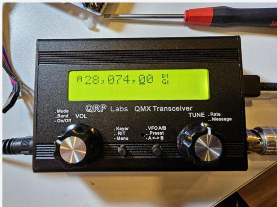
El QMX es un transceptor multibanda de 5 W que cubre 80, 60, 40, 30 y 20 metros. Incluye un receptor SDR integrado, una tarjeta de sonido USB de 24 bits a 48 kbps, control CAT por puerto USB y un oscilador de referencia TCXO. Ofrece modos CW, digitales y SSB, además de funciones de baliza autónoma y generador de tonos para ajuste de antenas.
