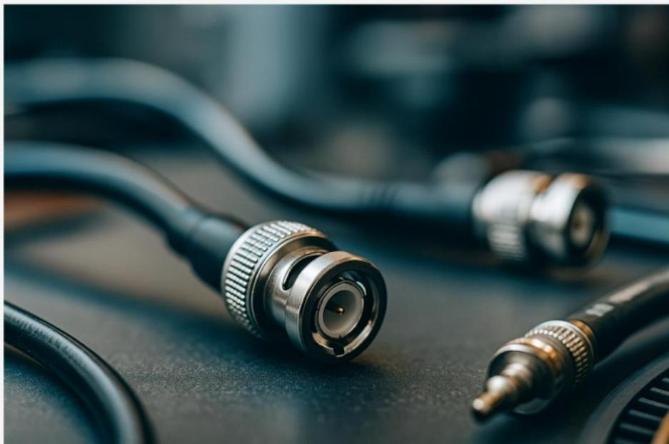
Los conectores son igualmente importantes. El PL-259 (UHF) es popular en HF por su robustez pero no es estanco; el tipo N ofrece mejor rendimiento en VHF/UHF y sellado. Para frecuencias de microondas conviene emplear conectores SMA o BNC de baja pérdida. Asegúrese de crimpar o soldar adecuadamente para evitar falsas conexiones.
