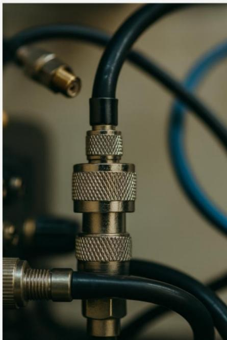
A menudo se considera que el coaxial es un simple accesorio, pero es el héroe invisible de cualquier estación. Un cable coaxial de calidad minimiza las pérdidas, protege de la interferencia y asegura que la potencia llegue íntegra a la antena. Revisar periódicamente su estado y sustituir cables envejecidos evita problemas de VSWR y ruido.
